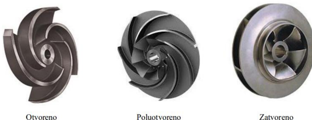
Slika 6. Vrste radnih kola [1]
