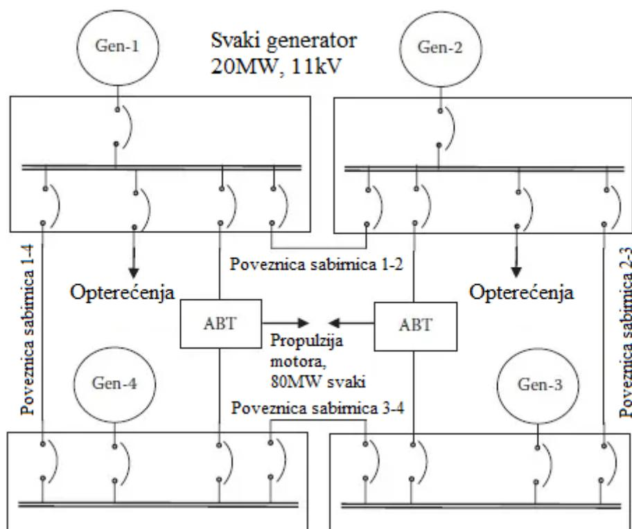
**Slika 5.** Prstenasta shema razvoda brodske električne energije [16]
