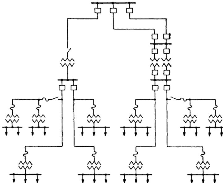
**Slika 4.** Radijalna shema razvoda brodske električne energije [15]
