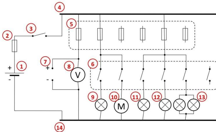
**Slika 1.** Shema tipične elektroenergetske instalacije broda [14],
