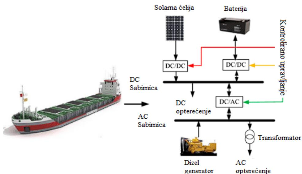
Slika 9. Hibridni elektroenergetski sustav broda [20]
