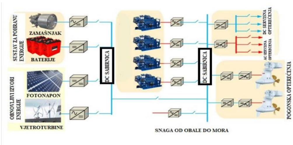
Slika 10. DC brodskog hibridnog elektroenergetskog sustava [21]
