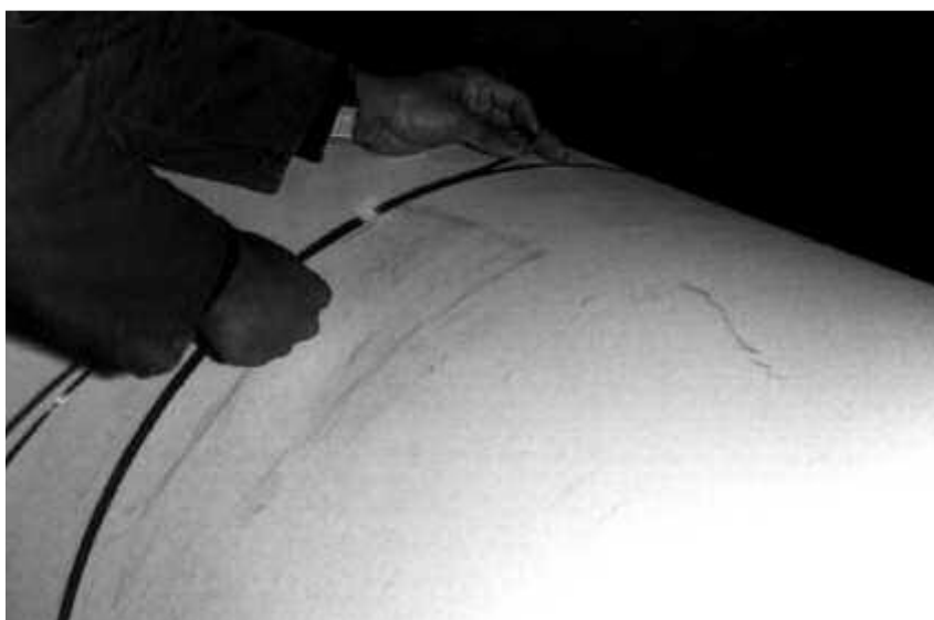
Slika 22. Mjerenje promjera ležaja pomoću Pi trake [10]
