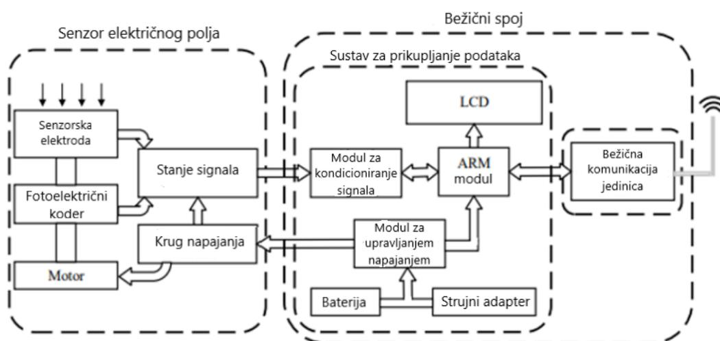
**Slika 21. Shematski dijagram bežičnog senzorskog čvora [22]**
