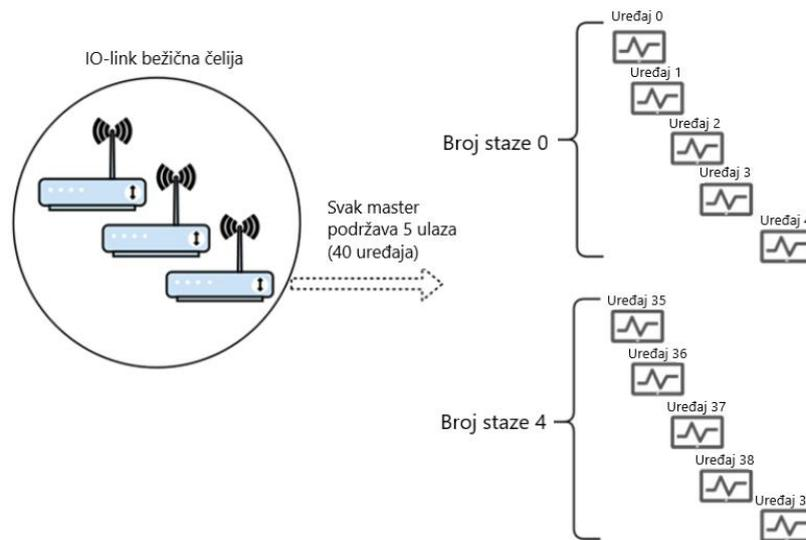
Slika 18. IO- link bežična distribuirana shema [21]
