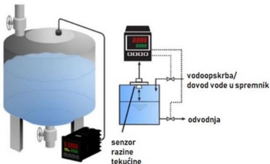
**Slika 3. Sustav kontrole razine tekućine u hidroforu [5]**
