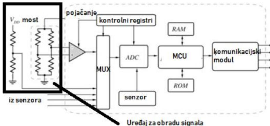
**Slika 7. Integrirani uređaj za obradu podataka [1]**
