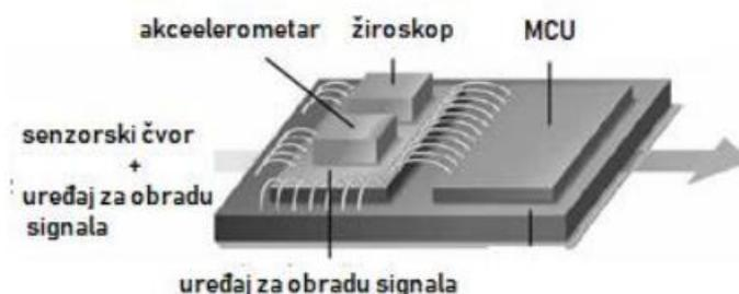
**Slika 12. Primjer integriranog pametnih senzora akcelerometra i žiroskopa [18]**
