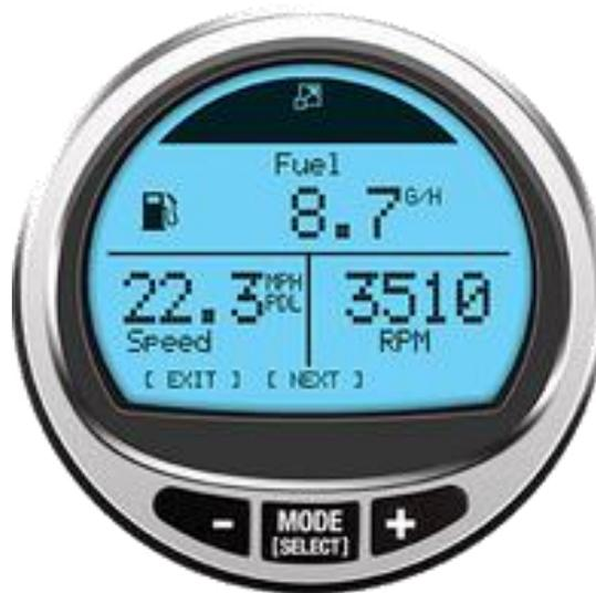
Slika 27. Mjerilo i zaslon Mercury monitora [26]
