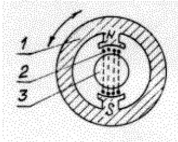
**Slika 40. Skica induktivnog davača električnog torziografa [30]**
