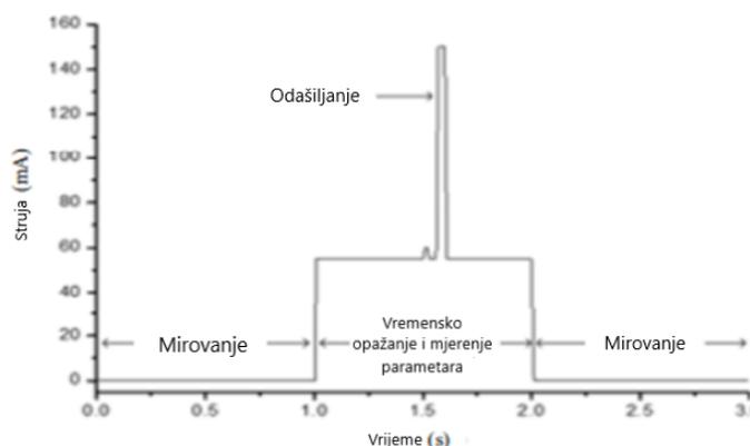
**Slika 22. Dijagram prijelaza stanja Xbee-Pro modula [22]**
