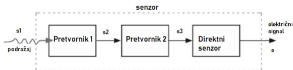
**Slika 4. Senzor s ugrađenih nekoliko pretvornika [1]**
