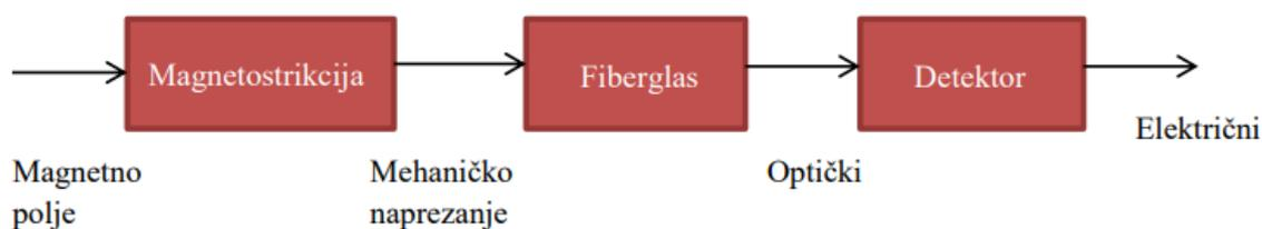
**Slika 8. Shema senzora fiberoptičkog polja[13]**
