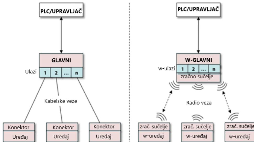
**Slika 16. Kompatibilna arhitektura žičanog IO- linka i bežičnog IO- linka [21]**
