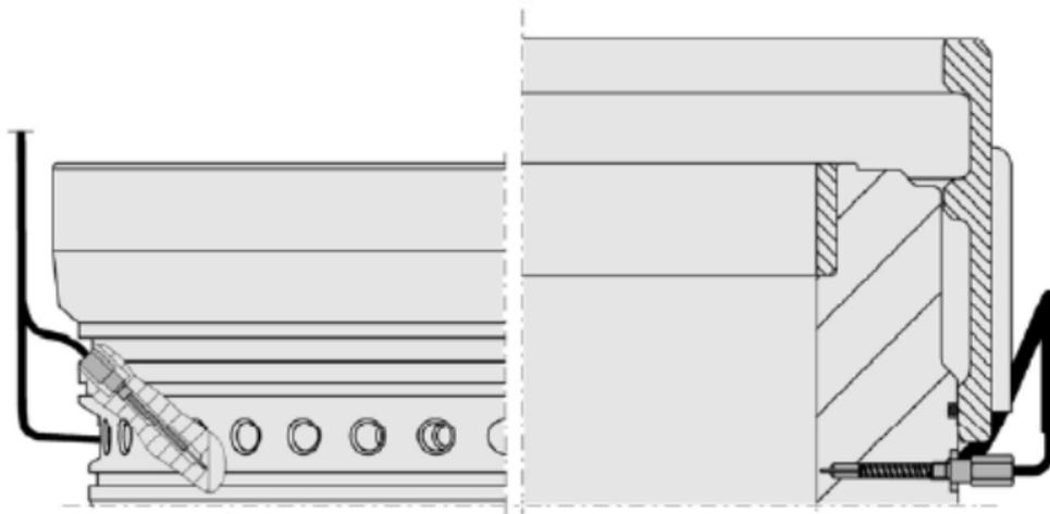
**Slika 35. Mjerenje temperature košuljice cilindra s termoparom [31]**
