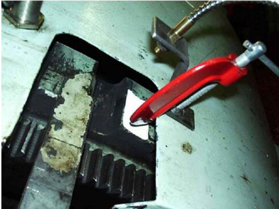
**Slika 39. Optički pick-up davač brzine vrtnje [30]**
