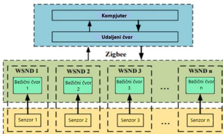
Slika 20. Sustav bežičnog sustava za mjerenje električnog polja [22]
