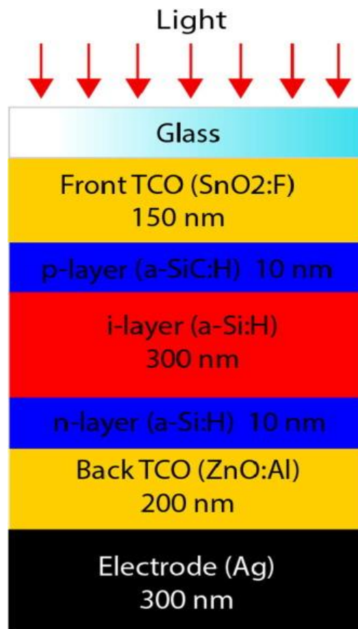
Slika 20. Struktura sunčane ćelije od amornog silicija [13]
