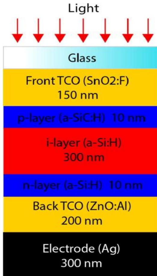
**Slika 20. Struktura sunčane čelije od amorfног silicija [13]**
