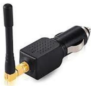
**Slika 11. Jednostavni GPS ometač [15]**
