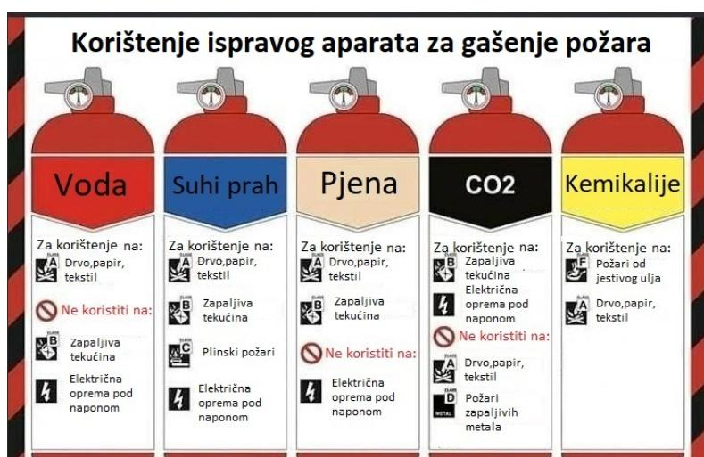
Slika 15. Vrste aparatata za gašenje požara [13]
