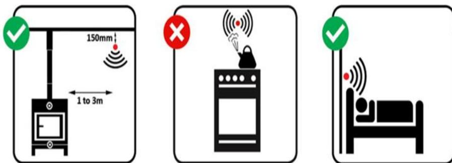
Slika 3. Postavljanje uređaja za detekciju CO [15]
