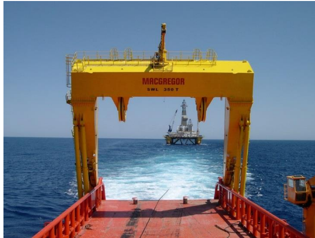
Slika 20. A okvir na krmenom dijelu broda [21]
