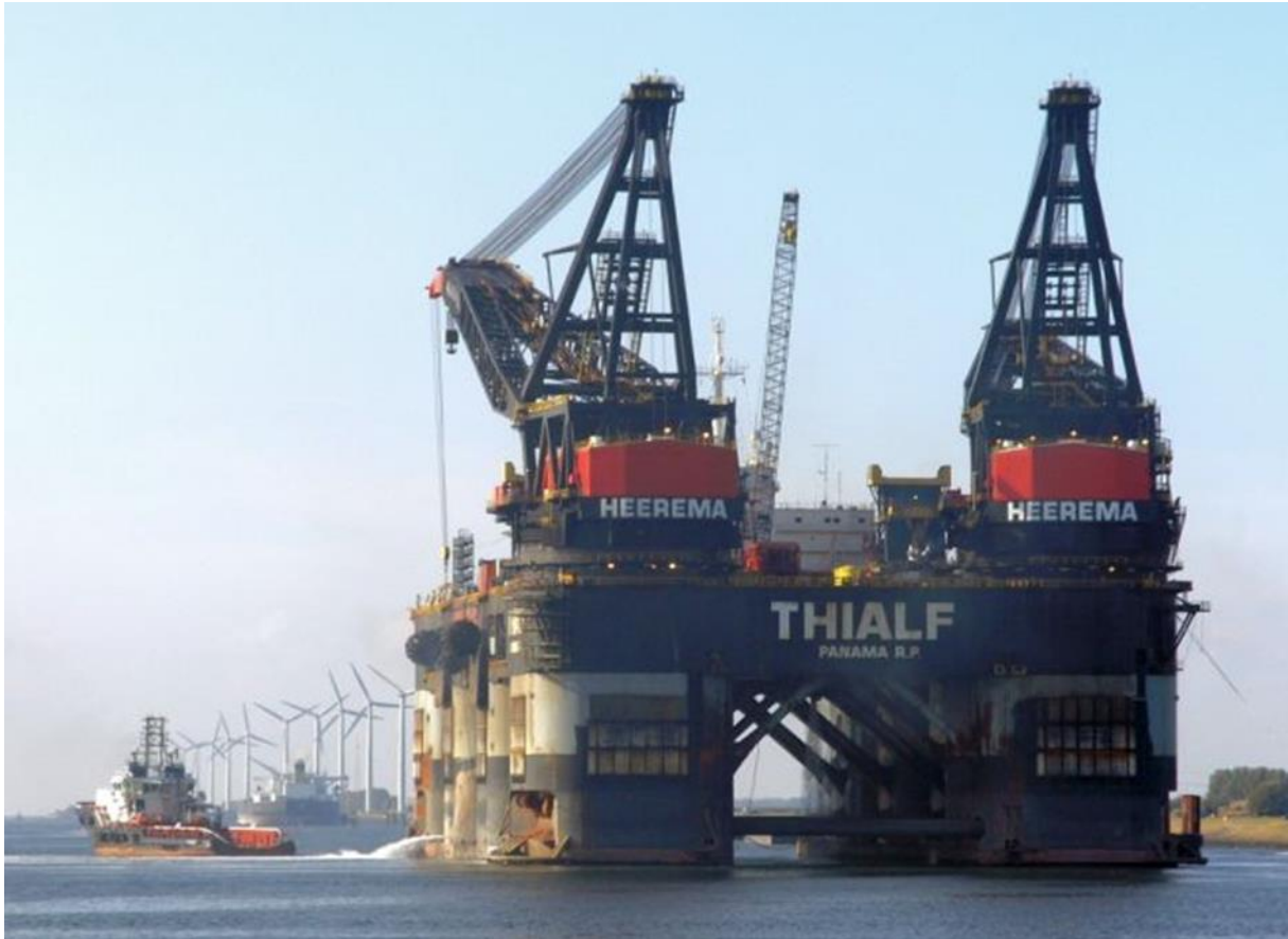
Slika 17. Dizalica poluuronjivog tipa SSCV Thialf [23]
