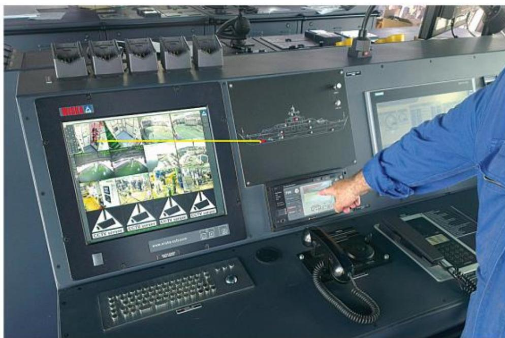
**Slika 3. Prikaz među veze CCTV video sustava i alarmnog sustava detekcije požara [1]**
