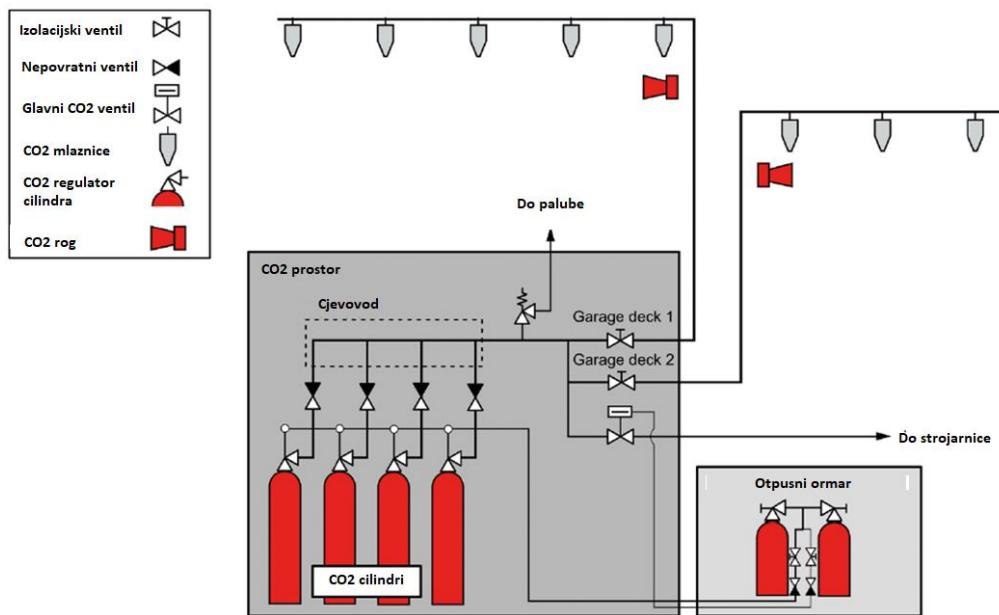
**Slika 13. Sustav za gašenje ugljičnim dioksidom [12]**
