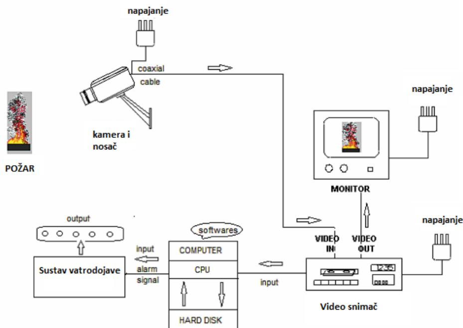
**Slika 4. Glavne komponente otkrivanja požara video kamerom [1]**
