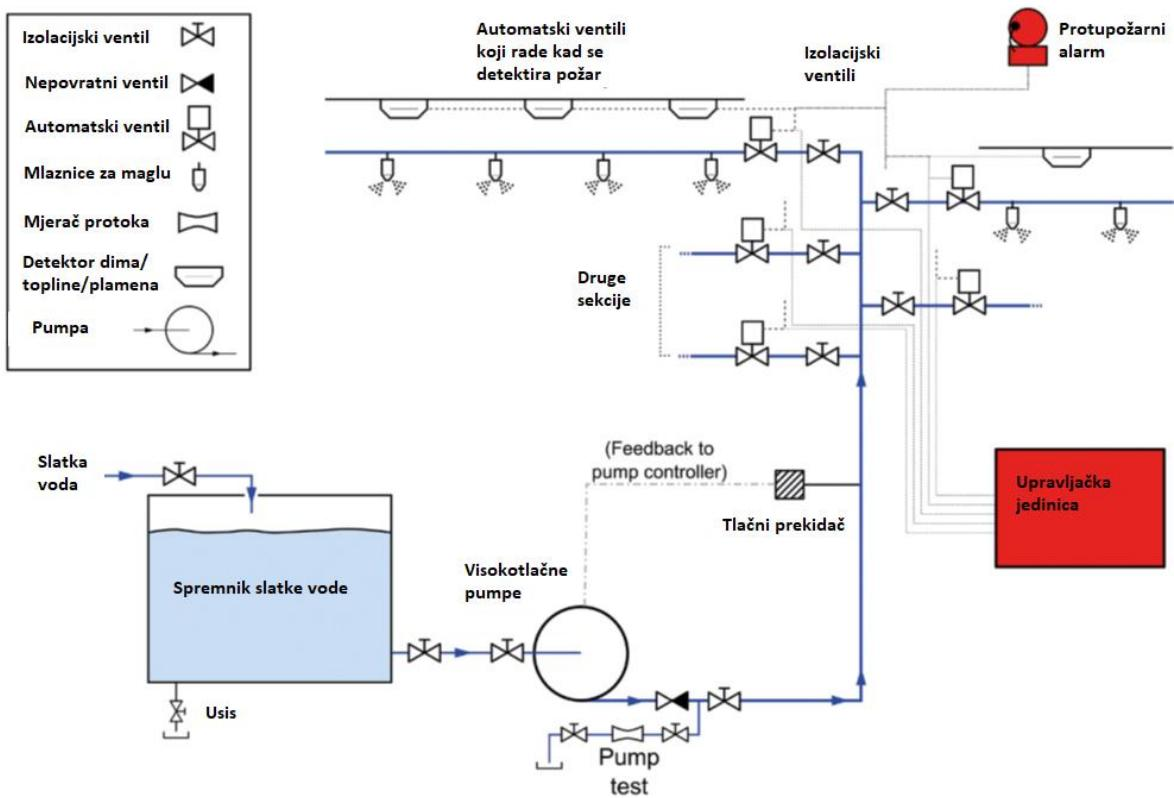
Slika 10. Sustav za gašenje požara vodenom maglom [12]
