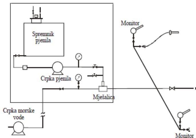
**Slika 12. Sustav za gašenje požara pjenom [11]**
