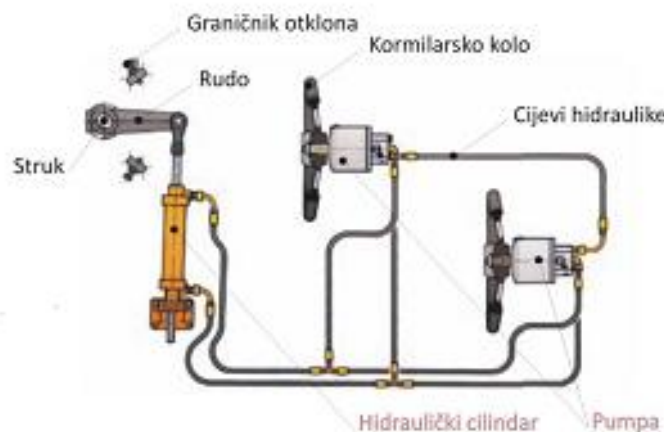
Slika 9. Hidraulična transmisija s dva kola [11]
