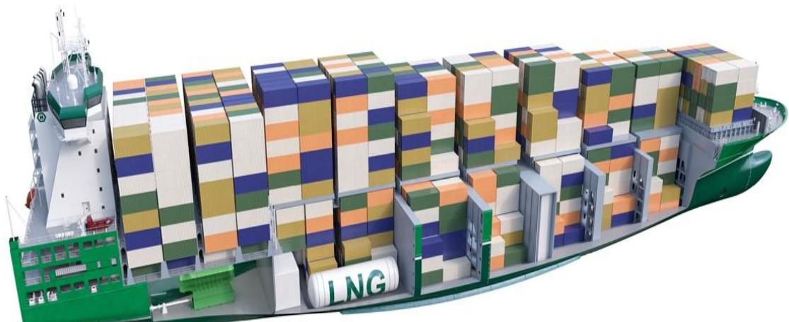
Slika 35. DNV GL-ov kontejner sa LNG pogonom [20]
