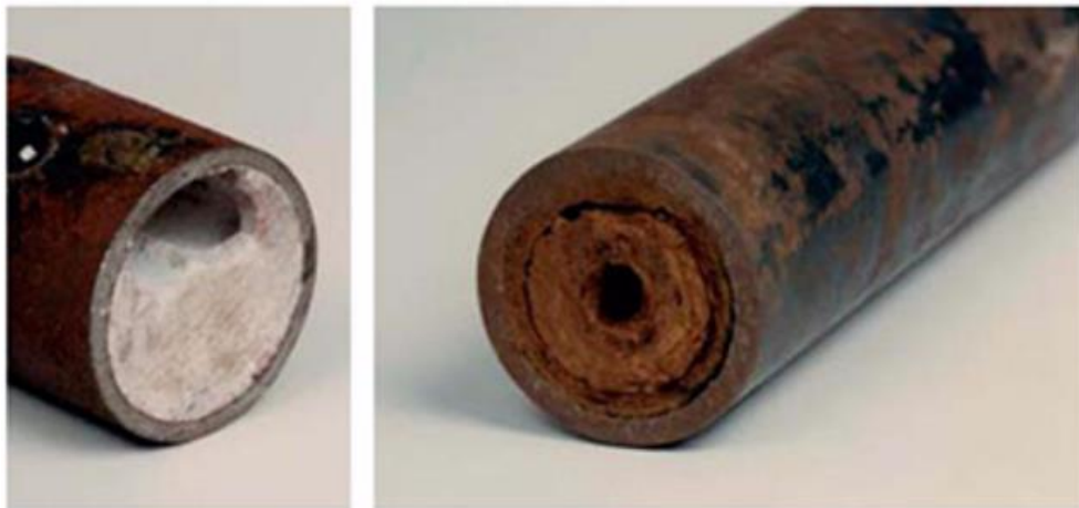
Slika 7. Nakupina kamenca unutar cijevi [10]
