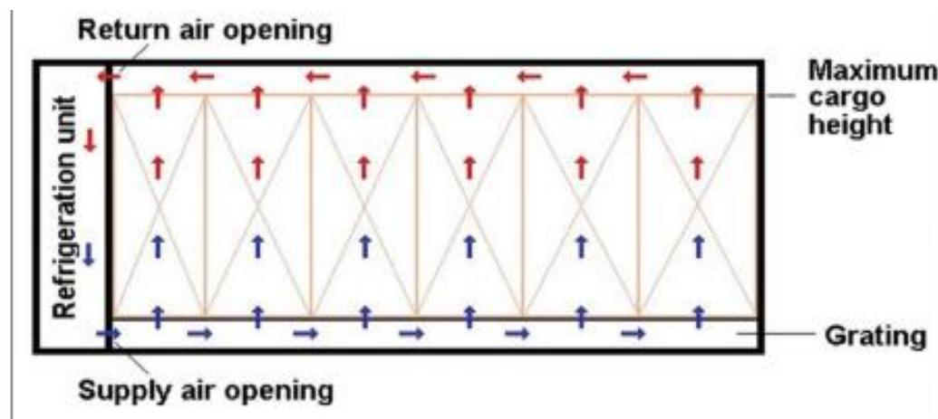
Kako bi se osiguralo da zrak može kružiti oko zamrznute robe bez prekida normalnog toka kruženja, unutrašnji zidovi kontejnera uglavnom sadrže žljebove (rebra). Dakle, čak i ako je roba postavljena direktno pored zida, zrak i dalje može kružiti kroz ove kanale i toplina koja dolazi izvana biva hlađena [15].
