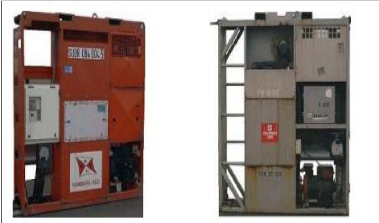
**Slika 7. Jedinice koje su prenosive i pričvršćuju se na kontejner [1]**
