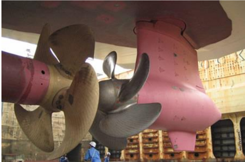
Slika 9. Prikaz kontra rotirajućih propelera [15]
