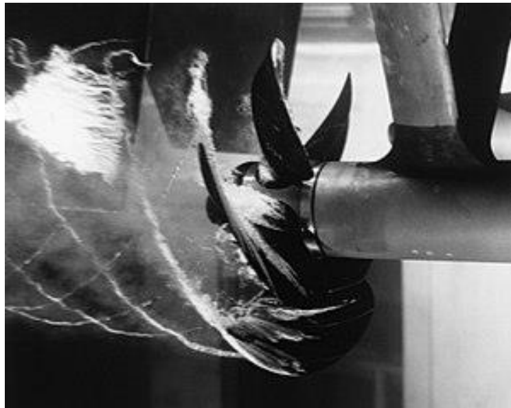
Slika 6. Brodski vijak na kojem se pojavljuje kavitacija [32]
