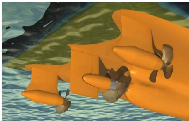
Slika 10. Primjer centralnog vijka s dva wing azipoda [5]
