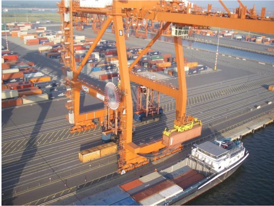
Slika 21. Extra post panamax dizalica na tračnicama u Amsterdamu [20]
