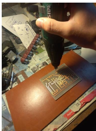
Slika 26 Bušenje rupa na pločici
